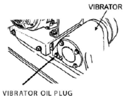
**Fig. 17 – Indicatorul de ulei la vibrator**
