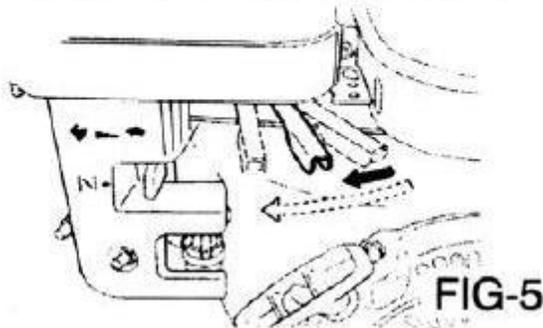
FIG-5 MÂNERUL DE ACCELERAȚIE
