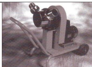
Figura 2.A – Exemplu de pompă de 50, 60 și 70 cu cărucior din metal acoperit cu vopsea emailată;
